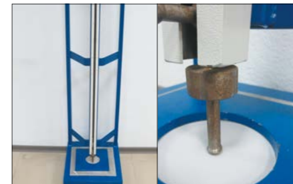
4.3.4 Общий вид установки для проведения испытания на ударную прочность
