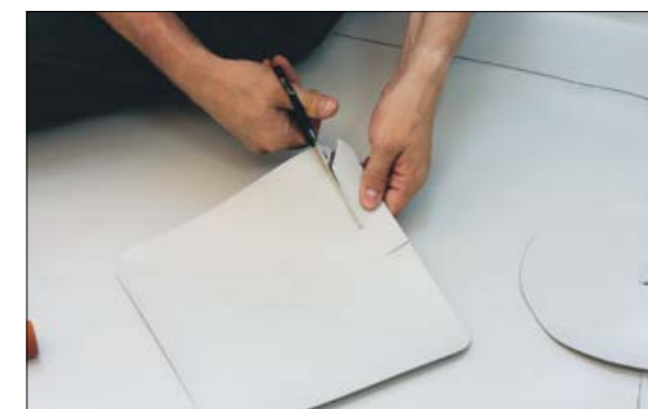
6. Вырезаем по полученной разметке полосу шириной 20 мм.
