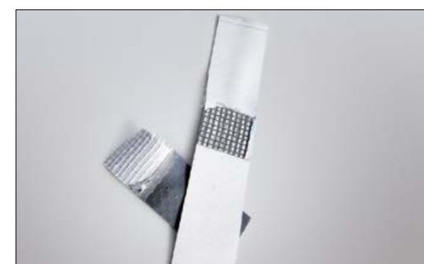
Рис. 5.2.10 Вырезание тестовой полоски из сварного шва
