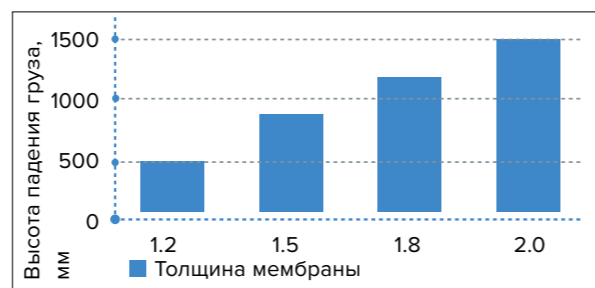
Рис. 4.3.2 Зависимость показателя ударной прочности от толщины мембраны
