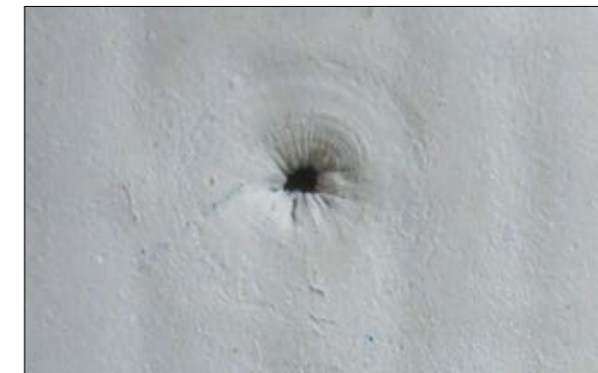
4.3.5 Повреждение на образце мембраны после испытания
