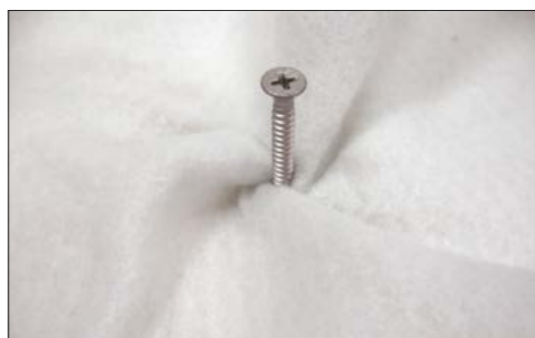
Рис. 3.3.2б Засверливание самореза в иглопробивной геотекстиль
