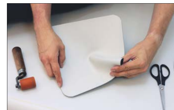
4. Складываем один из углов заготовки к середине, как показано на снимке.
