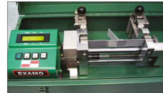
Рис. 5.2.5 Проверка качества сварного шва при помощи Leister Examo
