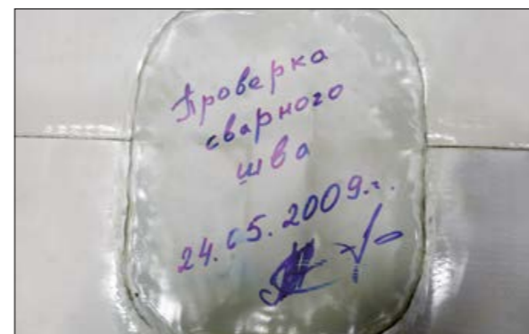
Рис. 5.2.12 Знак качества сварного шва
