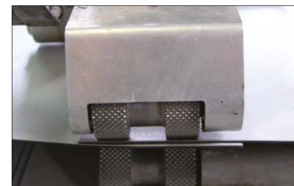
Рис. 5.2.11 Приводные ролики аппарата Twinny T
