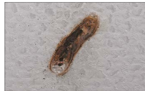
Образец мембраны толщиной 1,2 мм был прожжен насквозь. На кровле это может привести к протечкам.
