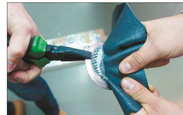
Рис. 2.3.4 Когезионный разрыв между полимерной мембраной и тарелкой с полимерным покрытием
