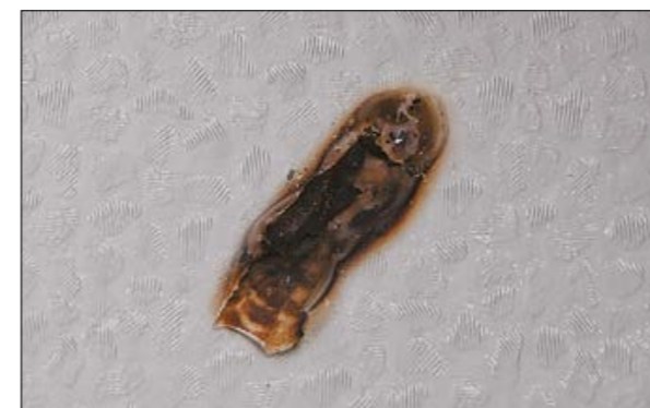
На образце мембраны толщиной 1,5 мм был поврежден только верхний слой.
