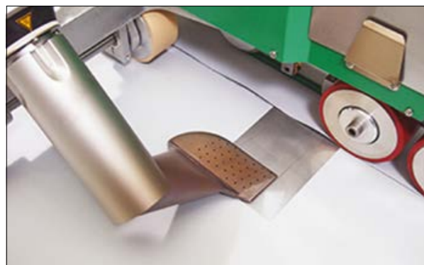
Рис. 5.2.6 Сварка с использованием металлической пластинки
