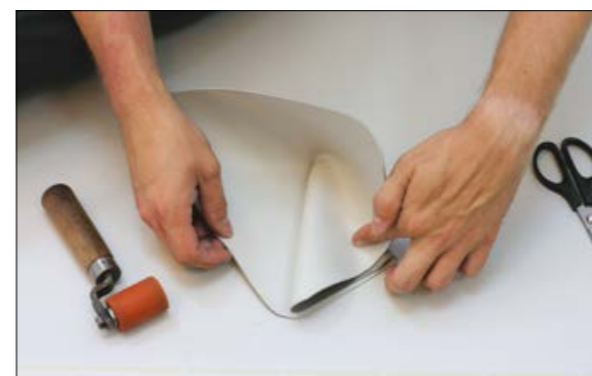
5. Прокатываем валиком полученную складку, тем самым размечая заготовку.
