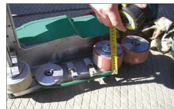
Рис. 3.5.5 Ширина рабочей поверхности Leister Varimat равная 60 мм
