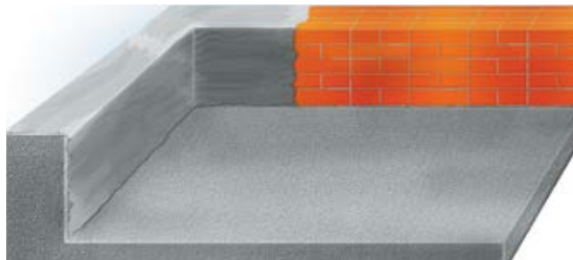
Рис. 7.14. Оштукатуривание вертикальной поверхности
