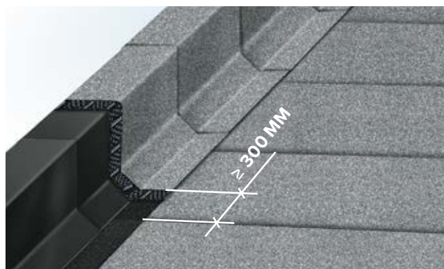
Рис. 7.20. Укладка верхнего дополнительного слоя на парапет
