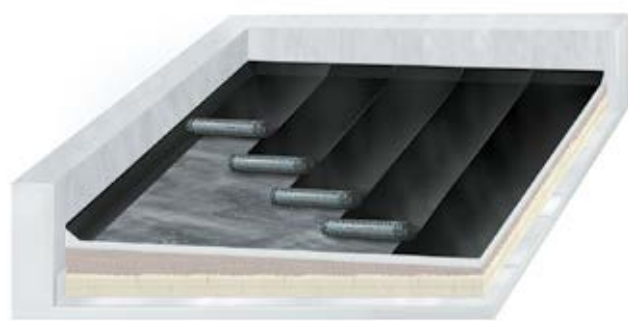
Рис. 7.17. 1 — Укладка материала перпендикулярно уклону при уклоне основания менее 15%;
