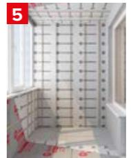
Перед монтажом финишного слоя (панелей МДФ, вагонки, пластиковых панелей) нужно организовать вентиляционный зазор, необходимый для прокладки коммуникаций (электрика, отопление, водоснабжение) без нарушения слоя пароизоляции с помощью контробрешетки из деревянных брусьев. Толщина зазора не менее 30-40 мм.
