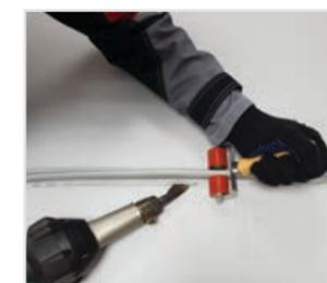
4. Производим окончательную сварку свободной от установленных прихваток стороны А-профиля.
