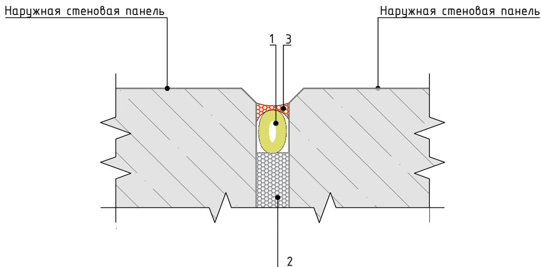
Геометрические размеры слоя герметика в шве
