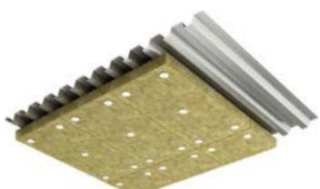
Необходимо приложить плиту из каменной ваты к защищаемой поверхности настила из стальных профилируемых листов и прикрепить самосверлящими самонарезающими винтами с надетыми на них шайбами к нижней полке профлиста. Винты вкручиваются в настил при помощи шуруповертов.
