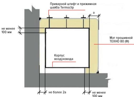
В случае, если расстояние между корпусами воздуховодов или корпусом и ограждающей конструкцией менее двух толщин огнезащитного покрытия, то маты фиксируются на доступной стороне и поджимаются в промежутке между конструкцией и корпусом. Необходимо тщательно заделать воздушную прослойку огнезащитным материалом со всех сторон на глубину не менее 100 мм.
