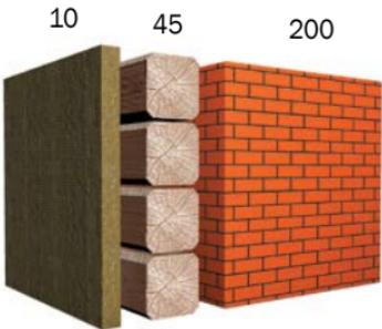
Пористая структура каменной ваты делает ее эффективным теплоизолирующим и звукоизолирующим многофункциональным материалом, который защищает конструкцию от огня, холода и шума.
