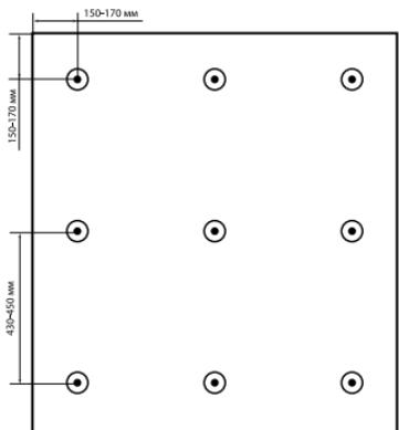
Количество крепежа на плиту 1200x1200 мм — 9 шт. Расположение крепежа симметрично, согласно схеме. Расстояние от центра крепежа до края плиты 150–170 мм. Количество крепежа для обрезанной части плиты рассчитывается как 1 крепежный элемент на 0,14 квадратных метра минераловатной плиты.
