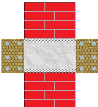
конструкция воздуховода должна предусматривать ребра жесткости в местах сопряжения из уголков. После монтажа огнезащитного покрытия место сопряжения воздуховода с несущими элементами здания заделывается цементно-песчаным раствором.
