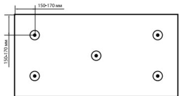
В зависимости от размера плиты ТЕХНО ОЗБ необходимо выбрать схему крепления огнезащитных плит и подобрать количество крепежа. Количество крепежа на плиту 1200x600 мм — 5 шт. Расположение крепежа симметрично, согласно схеме. Расстояние от центра крепежа до края плиты 150–170 мм.
