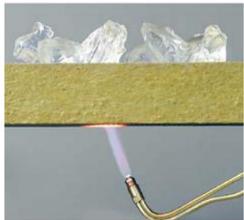
Материал выпускается в виде плит и матов различной плотности с разнообразными вариантами обкладочных материалов и прошивок. Благодаря неорганическому происхождению основного сырьевого компонента каменная вата является полностью негорючим материалом и способна эффективно защищать конструкции от воздействия высоких температур во время пожара.
