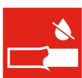
Вскрывать упаковку с материалом следует только непосредственно на месте монтажа. Разрешается применять только полностью сухой материал.
