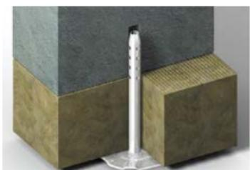
Подбор необходимой длины металлического тарельчатого анкера производится в зависимости от толщины огнезащитной плиты по принципу, что глубина анкеровки должна быть минимум 30 мм.
