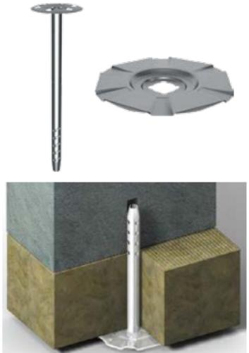
Анкер удерживает нагрузку за счет сил трения, образуемых в результате распрямления пружины в базовом материале, и частичного упора по поверхности стержня анкера.
