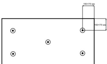
Для фиксации плиты ТЕХНО ОЗМ применяются шайбы, надеваемые на самосверлящие самонарезающие винты, диаметром не менее 50 мм. Количество крепежа на плиту 1200×600 мм — 5 шт.
