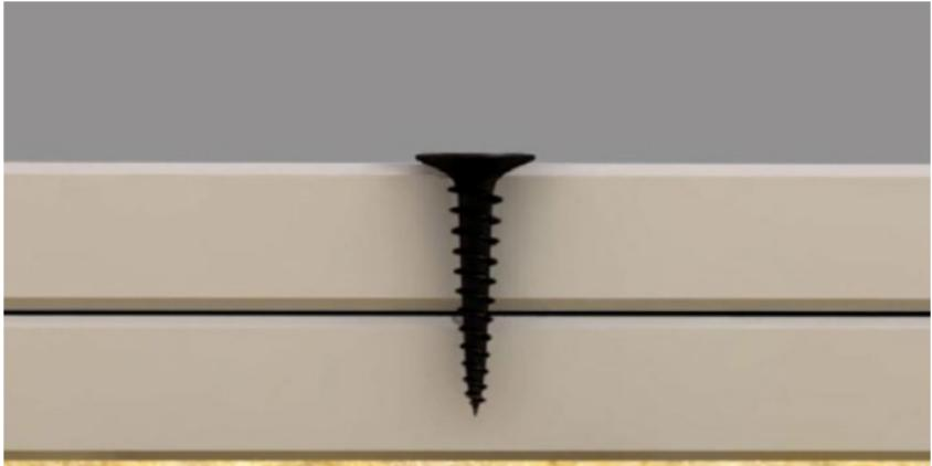
Рис. 11. Соединение двух листов сухой стяжки при помощи самореза
