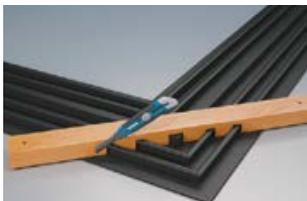
Подрежьте вершину угла на обоих дуговых элементах, как показано на рисунке.
