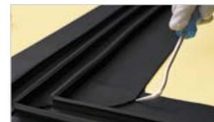
Элемент «поворот» под **90°** готов. Проверьте качество сварных соединений.
