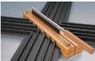
После равномерного оплавления торцов шпонок извлеките нагревательный элемент и с силой прижмите зажимы друг к другу.
