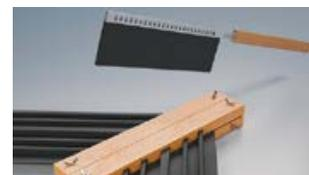
После остывания демонтируйте зажим. Ножом срежьте валик расплавленного материала, образовавшийся по периметру сварного соединения.
