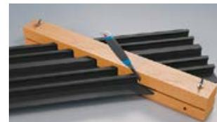
Разожмите кондуктор и вставьте шпонку таким образом, чтобы она немного высовывалась из кондуктора, и снова зажмите.
