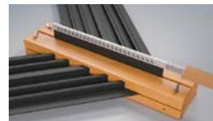
После равномерного оплавления торцов шпонок извлеките нагревательный элемент и с силой прижмите зажимы друг к другу.
