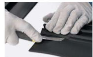
После того как ребра удалены, обязательно скруглите острые углы. Заготовка 2 готова.
