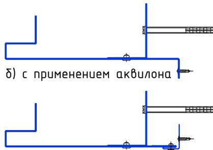
1. Высота (а)/ширина поперечного сечения выступов элемента верхнего и боковых откосов, а так же вылет (b) за плоскость фасада и размер (с) верхнего и боковых откосов определяется требованиями заключения об огневых испытаниях.
