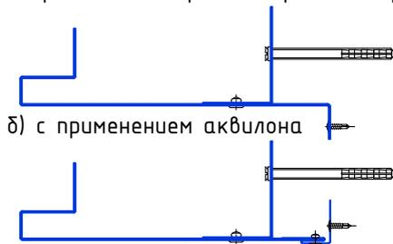
1. Высота (а)/ширина поперечного сечения выступов элемента верхнего и боковых откосов, а так же вылет (b) за плоскость фасада и размер (с) верхнего и боковых откосов определяется требованиями заключения об огневых испытаниях.
