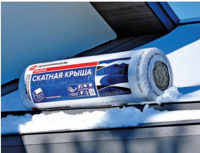
В основе системы утепления лежит негорючая минеральная изоляция ТЕХНОНИКОЛЬ Скатная крыша. Материал выпускается в рулонах, что позволяет нарезать продукцию и вдоль, и поперек, минимизируя количество отходов, а повышенная упругость волокна позволяет надежно фиксировать его в конструкции.
