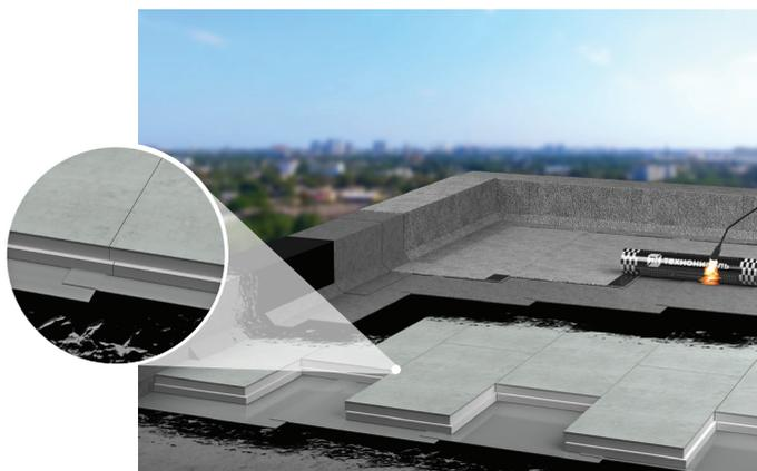
**Теплоизоляционные панели Сэндвич ТЕХНОНИКОЛЬ Ц-XPS – готовое решение для устройства любого вида плоской кровли!**
