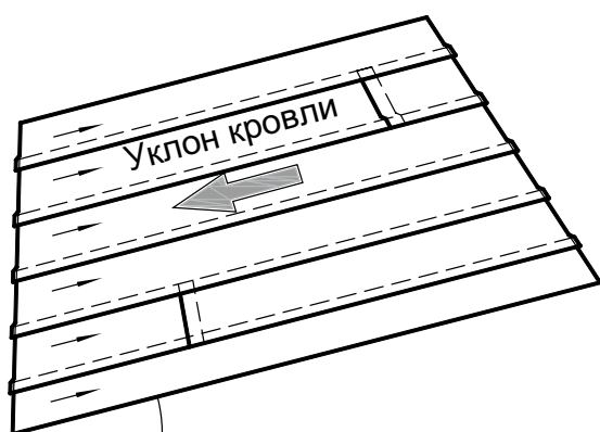
Рисунок Е.2 — Укладка материала на скате крыши параллельно уклону
