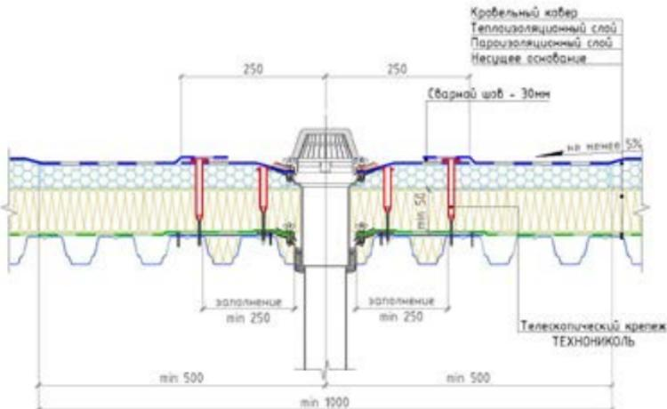
**5.2.9.** Для организации местного водопонижения необходимо выполнить подрезку утеплителя с учётом размеров и формы чаши водосточной воронки.
