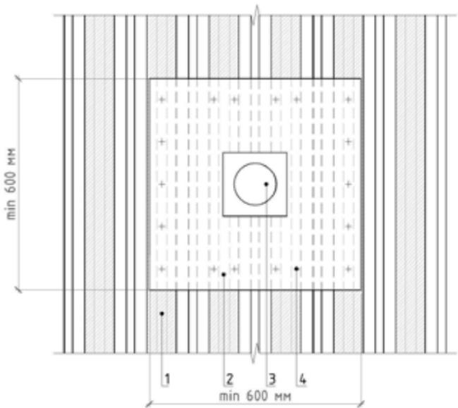
**ВАЖНО!** Фартук усиления должен заходить на две соседние волны профнастила от оси установки воронки.
