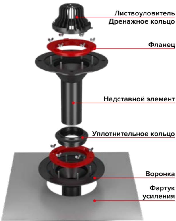
**5.2.1.** Установить водосточную воронку в заранее подготовленное место в несущем основании. Посадочный диаметр водосточных воронок ТЕХНОНИКОЛЬ при установке в несущее основание – 280 мм.
