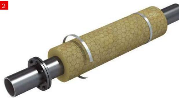
После установки матов с наружной поверхности их необходимо закрепить при помощи металлических бандажей из стальной ленты 18–25 мм или кольцами из проволоки 300–600 мм.
