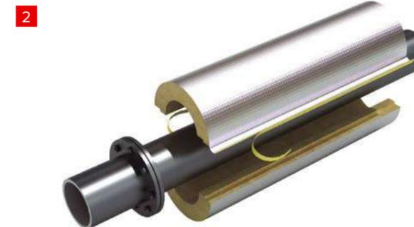
Цилиндры, состоящие из двух и более сегментов, устанавливаются на трубу по диаметру, плотно прижимая сегмент к сегменту. Продольные стыки располагают под углом к вертикальной оси окружности трубы. Сегменты, кашированные фольгой, сначала проклеивают самоклеющимся нахлестом с одной стороны, надевают сегменты на трубу и после этого проклеивают стык с обратной стороны.
