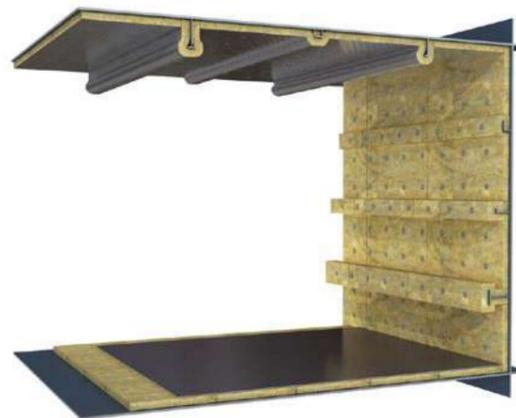
Плиты с покрытием могут быть хорошим законченным изоляционным решением для огнезащиты палуб, например, в машинном отделении (где нет высоких требований к облицовочному материалу). Материалы с покрытием обеспечивают чистую поверхность, не требующую больших усилий при техническом обслуживании. В качестве покрытия могут применяться стеклохолст и армированная алюминиевая фольга.
