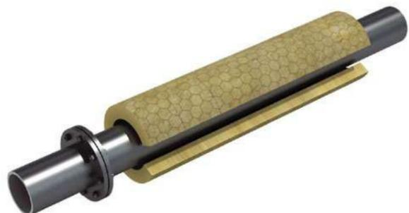
Теплоизоляционные изделия в виде матов наматываются на трубопроводы большого диаметра в один или несколько слоев. При монтаже матов в несколько слоев рекомендуется выполнять перекрытие швов нижележащих матов.
