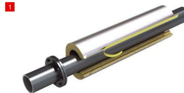
Наилучшим материалом для изоляции трубопроводов небольшого диаметра является Цилиндр ТЕХНО Судовой. Целый цилиндр (состоящий из одного сегмента) устанавливается раскрытием сегмента и надеванием на трубу. При этом на горизонтальные трубы цилиндр устанавливается таким образом, чтобы стык продольного шва располагался ниже линии горизонта. Если цилиндр каширован фольгой, то продольный стык проклеивается самоклеющимся нахлестом.
