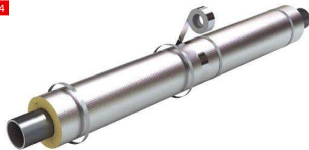
После установки цилиндров или сегментов их необходимо стянуть при помощи хомутов из металлической проволоки, оцинкованной проволоки, стальной или пластиковой ленты. Шаг крепления для проволоки – не более 300 мм, а для ленты – 600 мм. Проволока фиксируется скруткой, а лента – бандажными пряжками.
