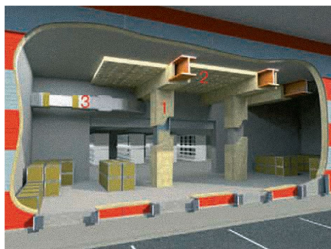
Рис. 1.4. Системы пассивной противопожарной защиты
