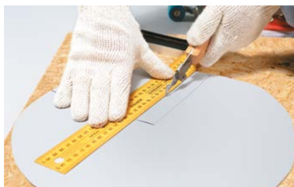
16. Отступив на 20 мм от линии сгиба, сделайте разрез кровельным ножом.
