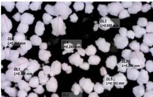
Рис. 4.1.2. ПВХ с высокой молекулярной массой (большие глобулы).
