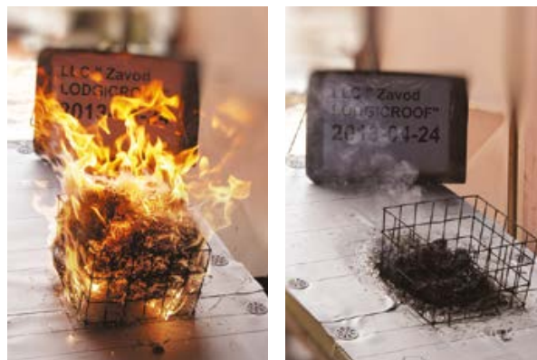
Рис. 4.5.10. Испытание по европейскому методу EN 1197, Test 1.
