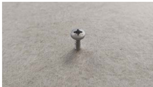
Рис. 3.4.2 а. Засверливание самореза в термообработанный геотекстиль.
