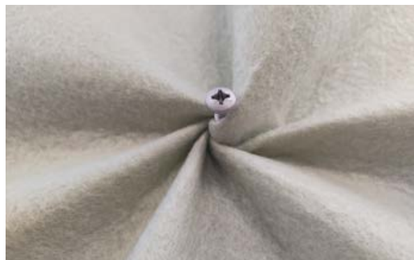
Рис. 3.4.2 б. Засверливание самореза в иглопробивной геотекстиль без термического скрепления волокон.
