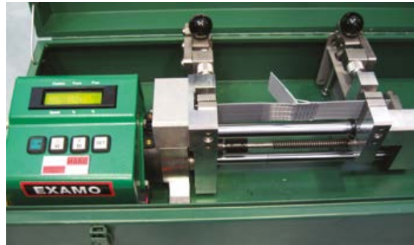
Рис. 5.2.6. Проверка качества сварного шва при помощи Leister Examo.
