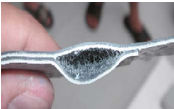
Рис. 3.6.5. Дефект сварного шва из-за некорректного нахлеста полотен ПМ.
