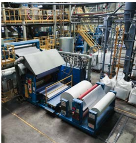
Рис. 4.1.1. Экструзионный способ производства ПВХ-мембран ТЕХНОНИКОЛЬ.
