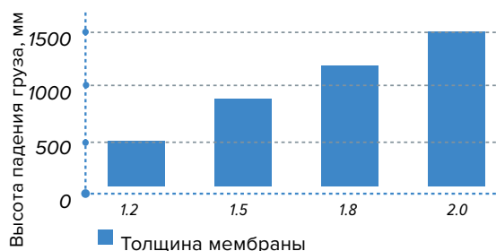
Рис. 4.5.2. Зависимость показателя ударной прочности от толщины мембраны.
