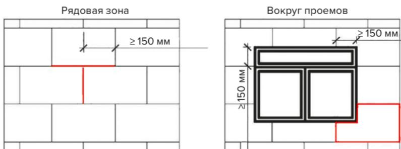
Рис. 7.33. Схема установки плит на плоскости фасада и вокруг проемов
