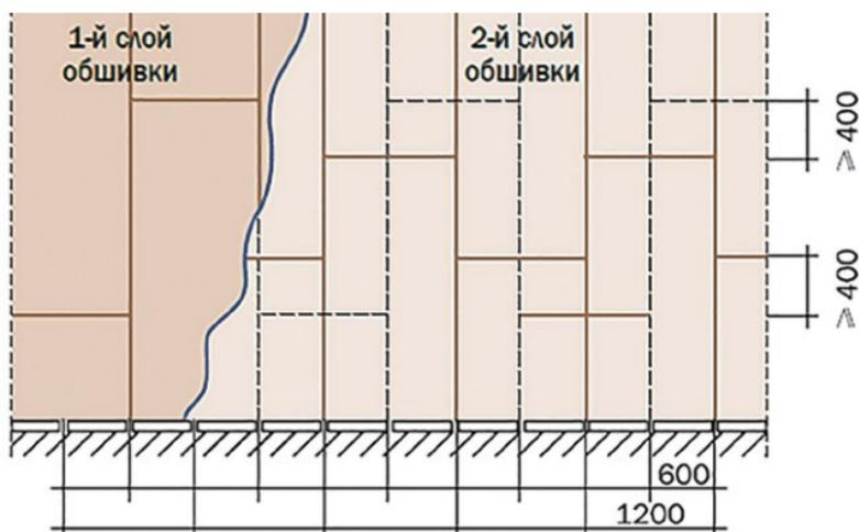
Рис. 7.24. Схема внутренней обшивки стен в два слоя
