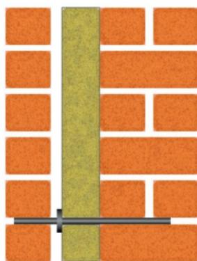
4. Укладывается теплоизоляция
