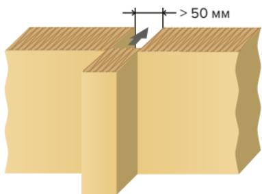
Рис. 1.7. Заполнение зазоров между плитами теплоизоляционного материала
