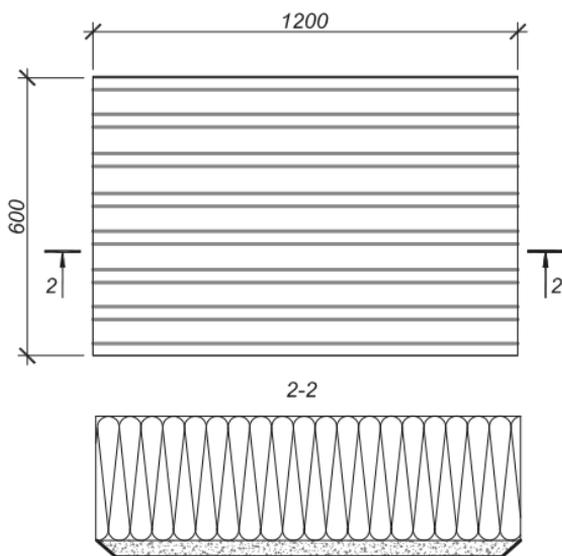
Рис. 7.29. Схема нанесения клея сплошным методом
