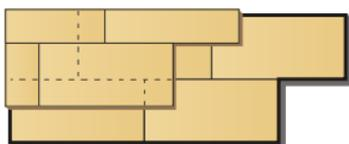
Рис. 1.10. Укладка плит с перекрытием швов при двухслойном утеплении
