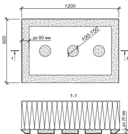
Рис. 7.30. Схема нанесения клея контурно-маячковым способом
