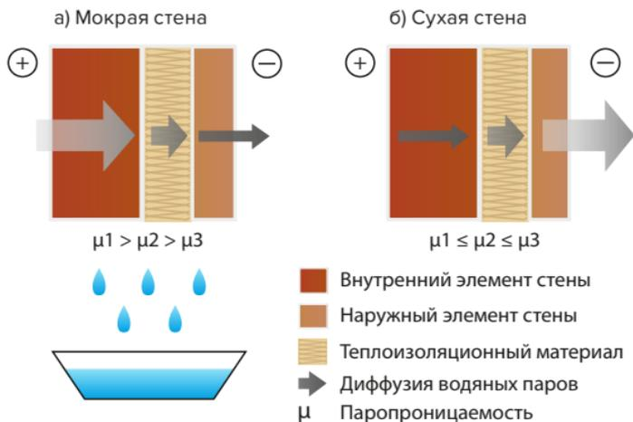
Рис. 1.6. Паропроницаемость слоев конструкции:
