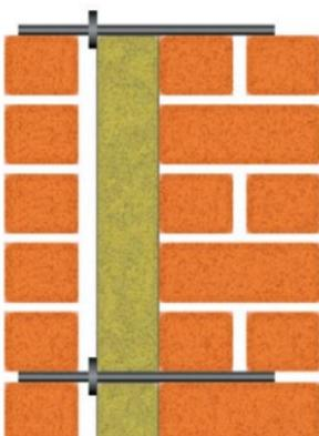
5. Ставятся гибкие связи с фиксатором зазора
