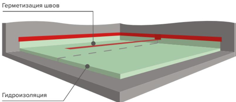
Рис. 5.10. Схема укладки гидроизоляционного слоя
