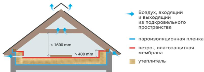
Рис. 4.8. Устройство вентиляции холодного чердака
