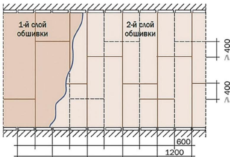
Рис. 6.12. Схема обшивки листами ГКЛ
