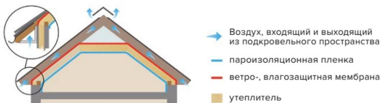
Рис. 4.1. Устройство вентиляции мансарды
