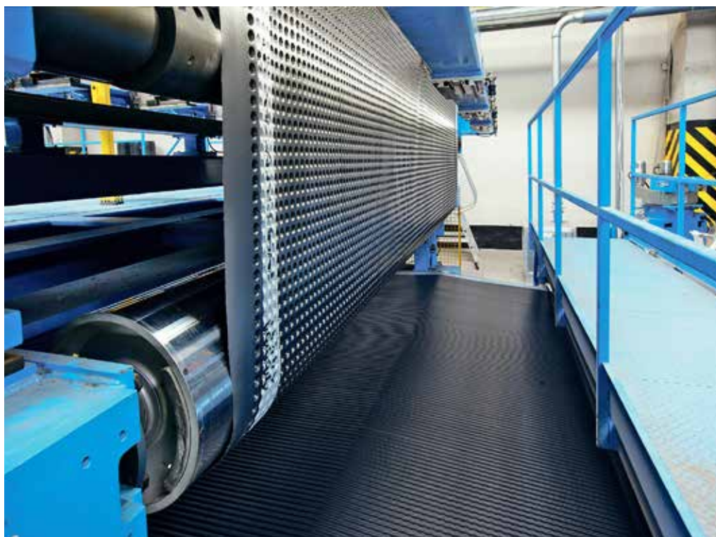
Производственная линия для изготовления профилированных мембран PLANTER – инновационного материала, который используется для комплексной защиты гидроизоляции конструктивных частей зданий и сооружений
