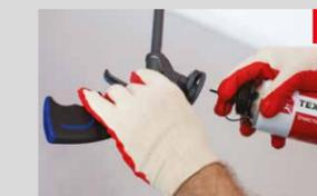
10 После завершения работ и в случае длительных пауз между работами необходимо тщательно очистить пистолет с помощью очистителя пены.
