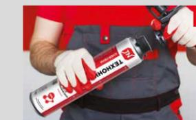
2 Снять с баллона защитный колпачок, навинтить пистолет на крестообразную насадку с резьбой «крест-кольцо».
