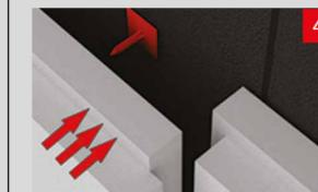
Установить плиты в проектное положение на гидроизоляции, плотно прижав к утепляемой поверхности.
