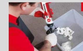
3 Отвернуть регулировочный винт пистолета, нажать на спусковой крючок, стравив некоторое количество пены.
