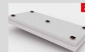
Проколоть плиты теплоизоляции крепежом N°01 или N°02, обеспечив рихтовочный зазор 5–10 мм между площадкой крепежа и плитой теплоизоляции.
