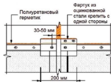
Рис. 27. Краевая рейка на стене из бетонных плит
