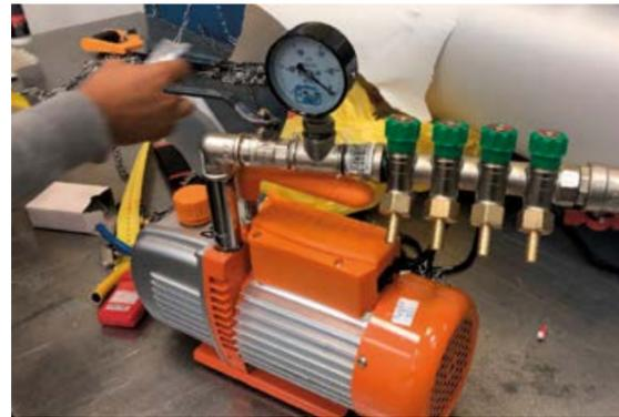
**7.4.6.** При подключении по схеме 2 трубки подсоединяются ко всем инъекционным штуцерам и к одной гребенке, оборудованной манометром (рис. 23).
