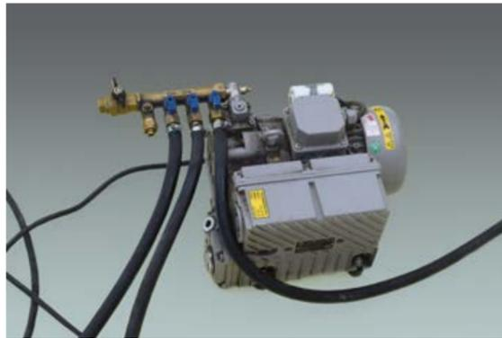
**Рис. 22.** Соединение трубок с вакуумным насосом
