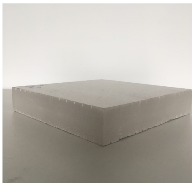
Рис. 10 Опытные образцы ТЕХНОНИКОЛЬ CARBON SOLID после испытаний
