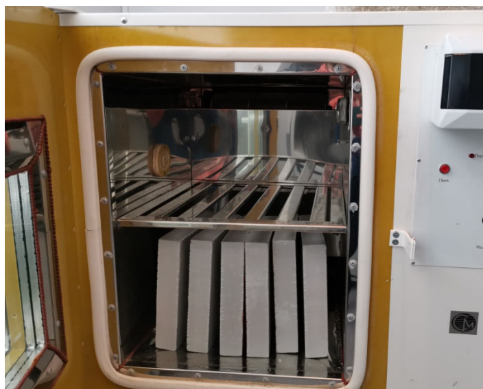
Рис. 2 Образцы в климатической камере в процессе испытаний
