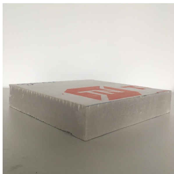
Рис. 7 Опытные образцы ТЕХНОНИКОЛЬ CARBON PROF после испытаний
