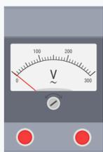
Он даёт возможность проверить работоспособность источников электрического тока.
