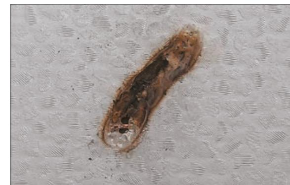
Образец мембранны толщиной 1,2 мм был прохожжен насекомым. На кровле это может привести к протечкам.
