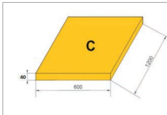
Рис. 3.3.13 Геометрия плит для создания контруклона LOGICPIR SLOPE 3,4 %
