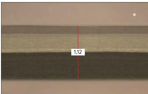
Рис. 4.3.8 Уменьшение толщины образца мембранны после испытаний в климатической камере после 10 условных лет.
