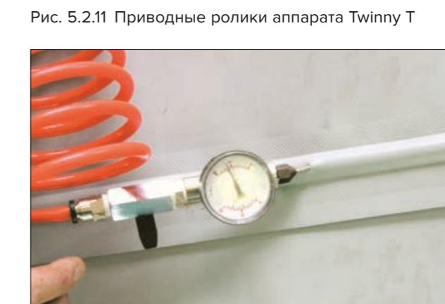
Рис. 5.2.13 Проверка герметичности с использованием сквозного канала
