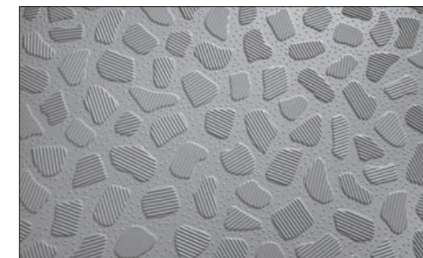
Рис. 3.4.6 Поверхность мембранны с тиснением
