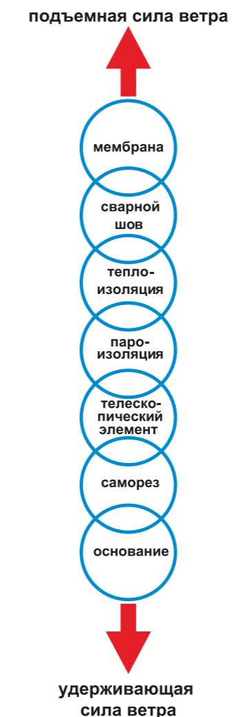
Рис. 3.5.3 Сопротивление подъемной силе ветра
