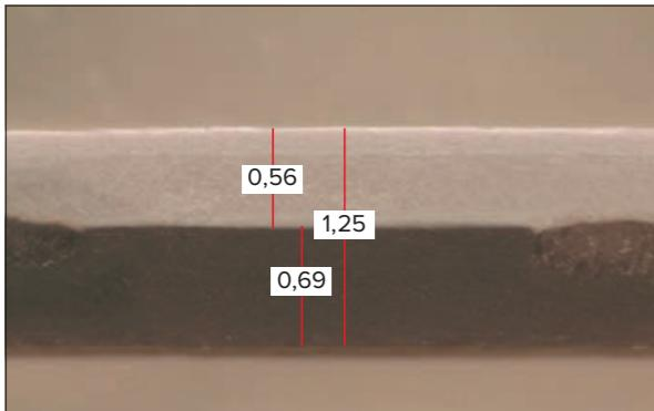
Вследствие воздействия климатических факторов и механического истирания толщина ПВХ мембраны на кровле с течением времени уменьшается. В зависимости от исходного качества материала и интенсивности воздействий уменьшение толщины материала будет происходить с разной скоростью.
