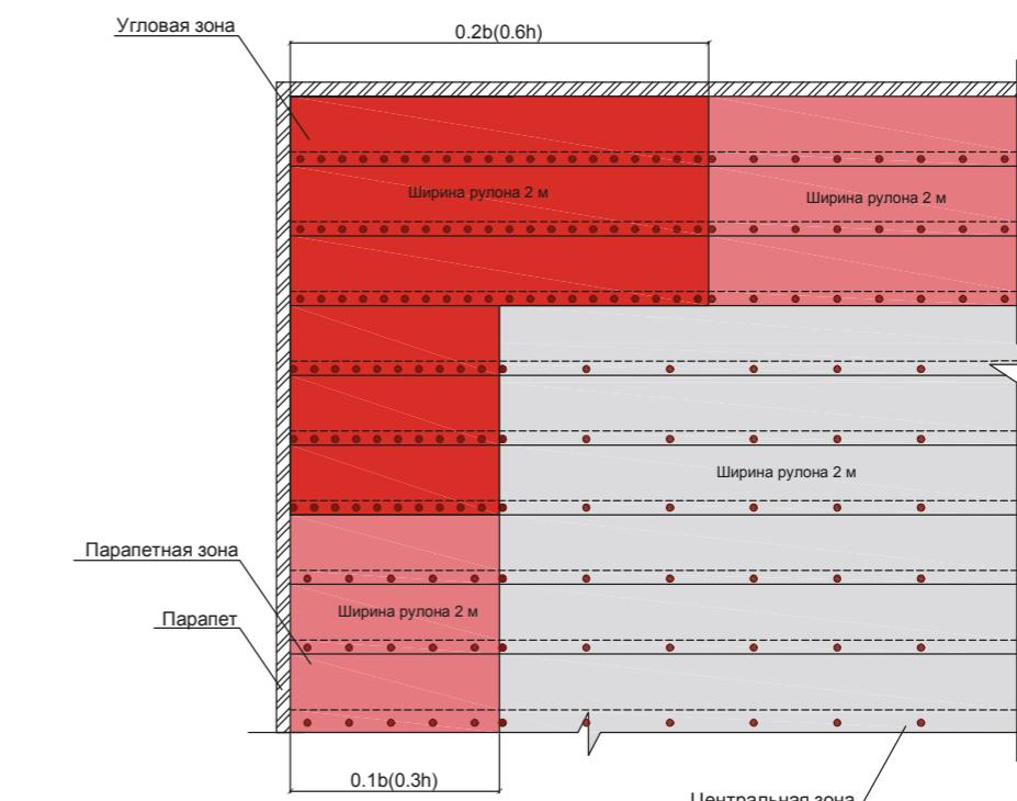
Рис. 3.5.14б Вариант раскладки и крепления полотнищ по бетонному основанию
