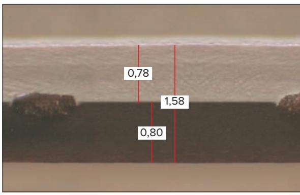
Рис. 4.3.7 На микроснимке с увеличением в 25 раз видно, что верхний слой мембранны LOGICROOF V-RP толщиной 1,5 мм примерно на 25 % больше, чем у мембранны LOGICROOF V-RP толщиной 1,2 мм.
