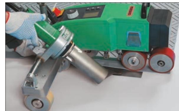
4. После сборки пешеходной дорожки в ряд приварите элементы к мемbrane, используя автоматическое сварочное оборудование. Для приваривания к кровле предусмотрены специальные полосы без тиснения вдоль краев элемента.
