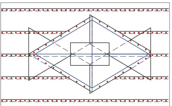
Рис. 3.3.11 Укладка ПВХ-мембраны в разуклонке из клиновидных плит
