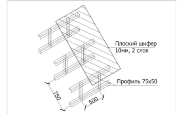
Рис. 3.3.5 Конструкция из профиля 75×50
