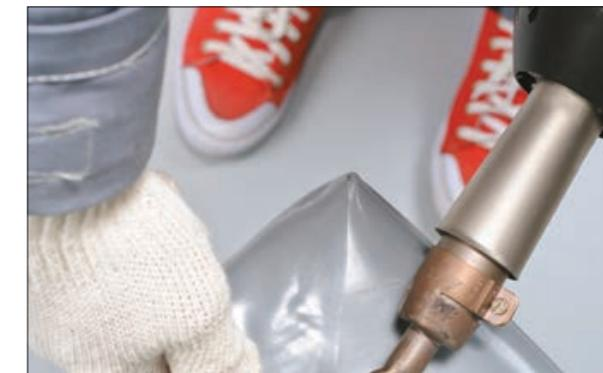
20. Выверните деталь наизнанку и проварите шов с внутренней стороны. Проверьте качество сварного шва пробником.
