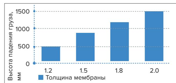
Рис. 4.3.2 Зависимость показателя ударной прочности от толщины мембранны
