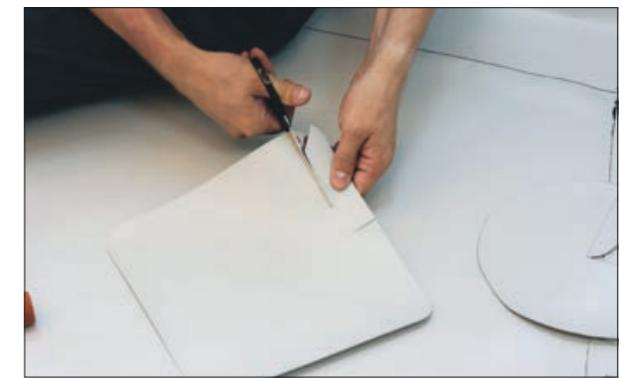
6. Вырезаем по полученной разметке полосу шириной 20 мм.
