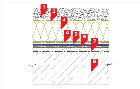
Рис. 2.8.4 Пример пирога инверсионной кровли
