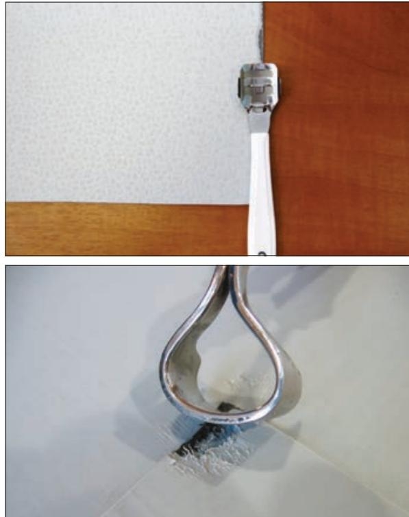
Рис. 5.2.14 Инструмент для подрезки нижнего полотна мембранны
