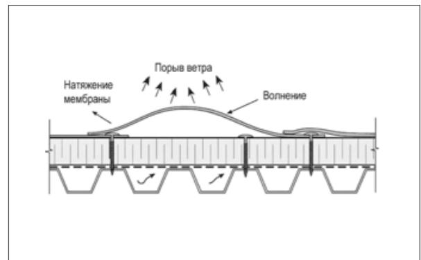
Рис. 2.1.1 Воздействие ветровых нагрузок на механически закрепленную мембрану
