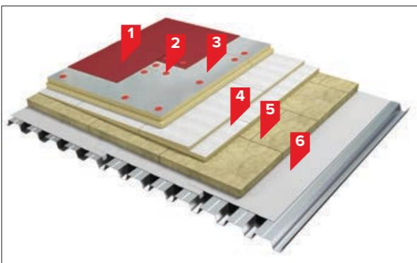
1. Полимерная мембрана LOGICROOF, ECOPLAST, ELVATOP или SINTOFOIL
