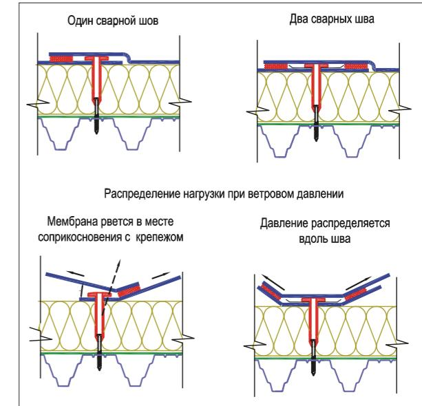
Рис. 3.5.16 Распределение нагрузки при ветровом давлении. Двойной шов
