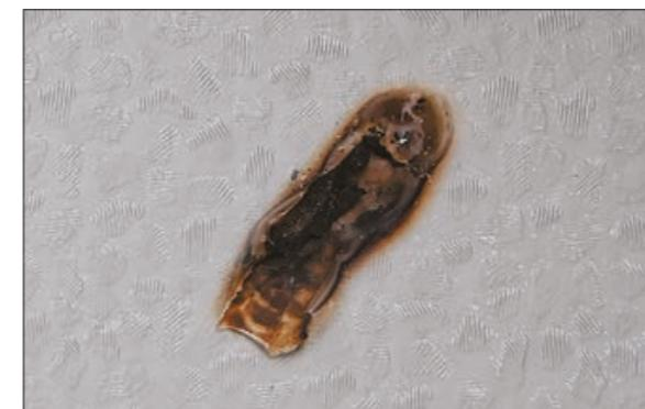
На образце мембранны толщиной 1,5 мм был поврежден только верхний слой.
