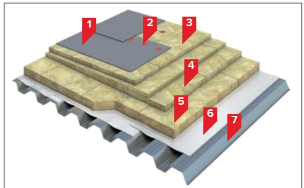
1. Полимерная мембрана LOGICROOF, ECOPLAST, ELVATOP или SINTOFOIL
