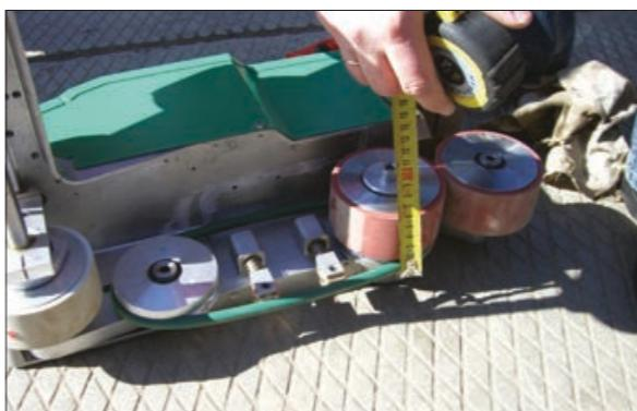
Рис. 3.5.5 Ширина рабочей поверхности Leister Varimat равна 60 мм
