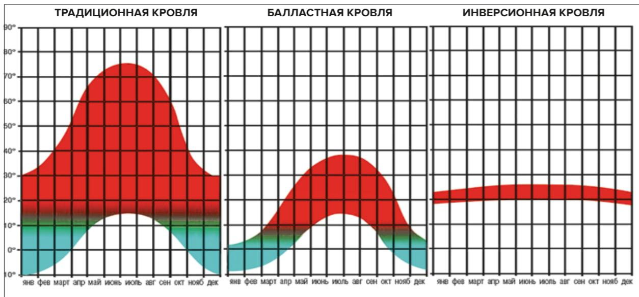
Рис. 2.8.3 Графики среднемесячных температур на поверхности кровельного ковра
