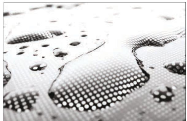
Одно из уникальных свойств ПВХ мембран ТЕХНОНИКОЛЬ — способность выводить в атмосферу избыточное давление пара из-под кровельного пространства. Избыточная влага, попавшая в утеплитель при монтаже или накапленная в холодный период, когда точка росы находится внутри утеплителя, выводится через мембрану в атмосферу.
