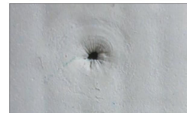
4.3.5 Повреждение на образце мембранны после испытания
