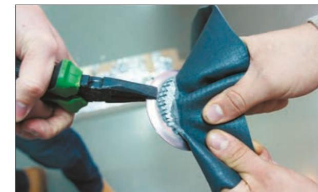
Рис. 2.3.4 Когезионный разрыв между полимерной мемброй и тарелкой с полимерным покрытием
