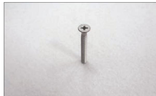
Рис. 3.3.2а Засверливание самореза в термообработанный геотекстиль
