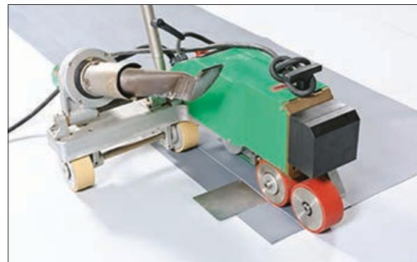
4. Со стороны нижнего края заготовки приварите полосу для кармана по длине с помощью автоматического оборудования.
