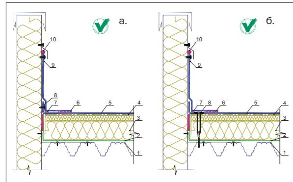
Рис. 3.6.6 Устройство классического примыкания кровельного ковра к вертикальной поверхности
