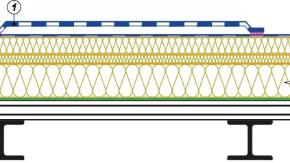
Рис. 3.6.6 Современный вариант устройства пешеходных дорожек из готовых элементов LOGICROOF WalkWay Puzzle
