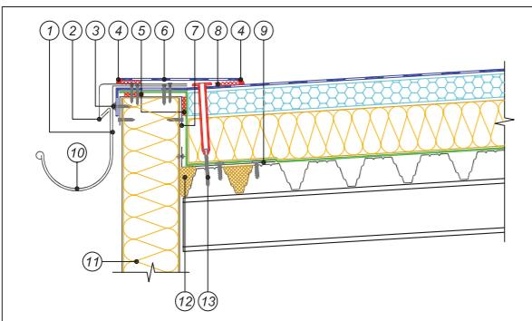
Рис. 4.8.3 Решение карнизного свеса с использованием ламинированного металла
