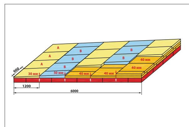
Рис. 3.3.10 Создание укона с помощью клиновидных плит
