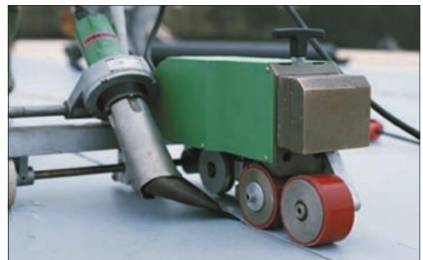
Рис. 5.2.1 Процесс автоматической сварки
