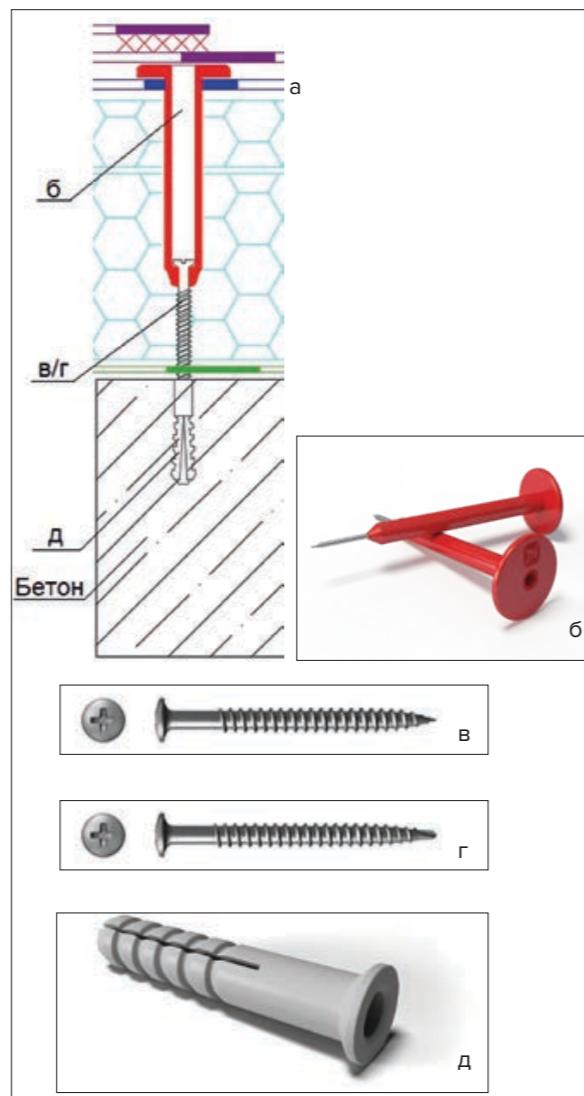
Рис. 2.10.2 Система механического крепления ТЕХНОНИКОЛЬ: а – общий вид смонтированного крепежа в бетонное основание, б – телескопический крепеж, в – саморез остроконечный Ø4,8 мм, г – саморез сверлоконечный Ø4,8 мм, д – анкерный элемент Ø8 мм
