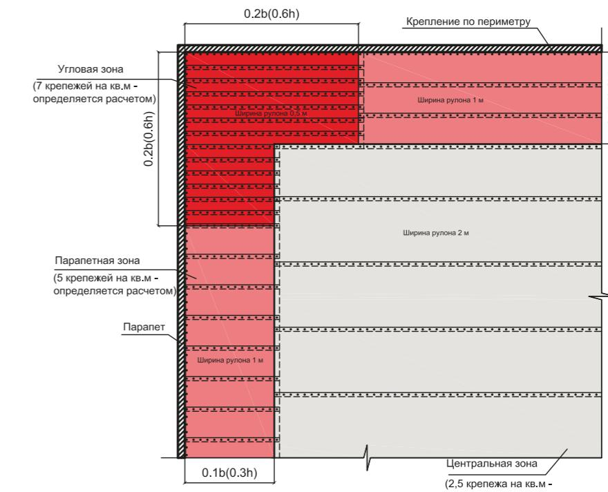
Рис. 3.5.14а Вариант раскладки и крепления полотнищ по профлисту
