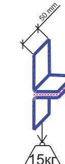
Рис. 5.2.2 Испытание сварного шва
