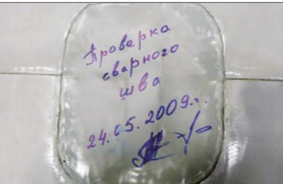
Рис. 5.2.12 Знак качества сварного шва
