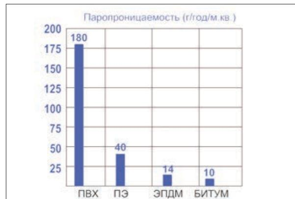
Рис. 3.1.1 Паропроницаемость (г/год, м<sup>2</sup>)
