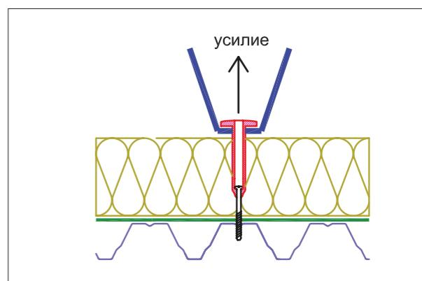
Рис. 3.5.8 Визуальный метод определения надежности установки крепежа
