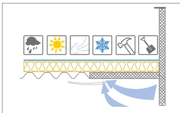
Рис. 2.1.2 Виды воздействий на кровлю без балласта
