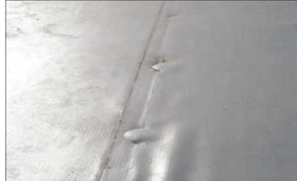
Рис. 3.5.7 Дефект сварного шва
