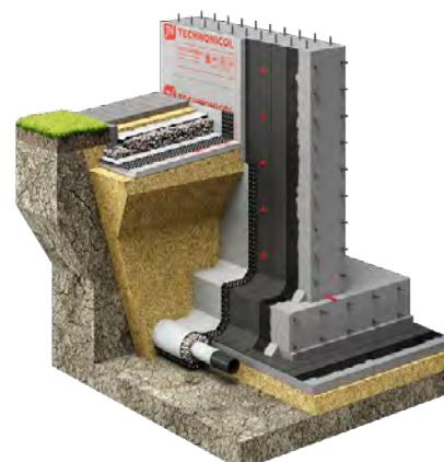
Рис. 2.8. Система ТН-ФУНДАМЕНТ Протект
