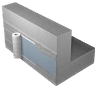
**2.** Гидроизоляционные ленты удобно применять в местах сопряжения различных элементов (например, при переходе с горизонтальной на вертикальную поверхность). Благодаря своей эластичности лента без труда укладывается в месте примыкания «пол – стена».
