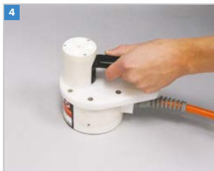
При помощи встроенного в индукционную машинку металлоискателя определяют положение металлических тарелок. Световая индикация на индукторе сигнализирует о нахождении и центровке металлической тарелки под мембраной, после чего запускается процесс автоматической сварки.
