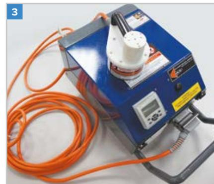
После этого используют аппарат индукционной сварки: ведут поиск металлической тарелки под мембраной с помощью встроенного металлоискателя.
