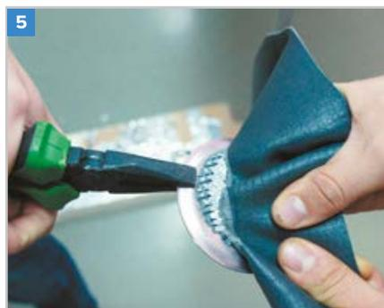
Мембрана прочно приваривается к полимерному покрытию металлической тарелки, при этом прочность сварного соединения превышает прочность самой мембраны.
