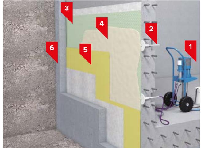
Б.) Инъектирование двухслойной системы гидроизоляции
