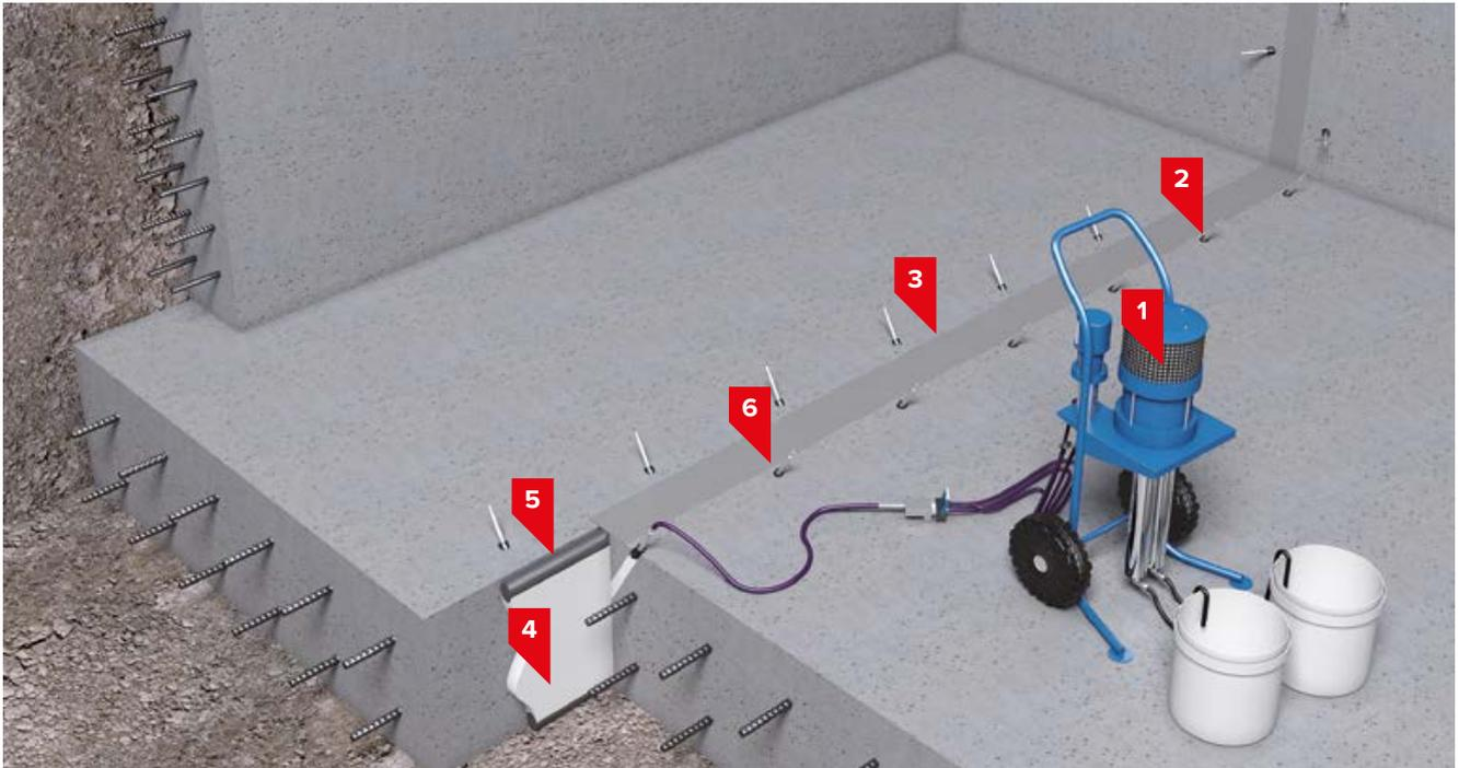
1. Двухкомпонентный инъекционный насос для акрилатных гелей с пропорцией смешивания 1 к 1
