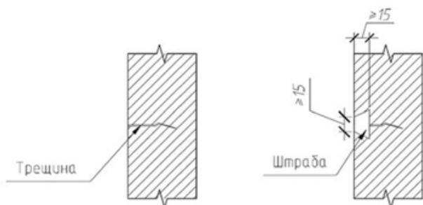
**Рисунок 8.1 – Схема выполнения штрабы**
