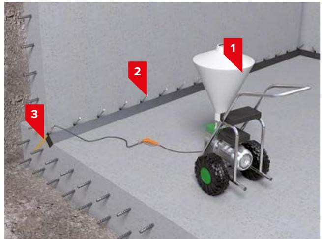
1. Электрический поршневой насос; 2. Инъекционные пакеры; 3. Трещина или технологический шов бетонирования.
