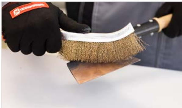
**Важно:** после каждого сварного контакта топорика с ГШ нужно счищать с инструмента остатки материала.
