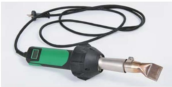
**7.6** Сварка гидрошпонок обоими способами заключается в нагревании (оплавлении) свариваемых поверхностей до вязкотекучего состояния полимера при непосредственном контакте их с нагретым инструментом или горячим воздухом и последующим соединением под давлением. Давление для соединения в зависимости от типа применяемого способа сварки может создаваться путем мускульной силы изолировщика, приложенной непосредственно к разогретым элементам гидрошпонки, прижимной струбцине или прокаточному ролику.
