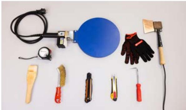
Рекомендуемое сварочное оборудование и комплектация для выполнения стыков гидрошпонок (ГШ): сварочный аппарат круглой формы; сварочный топорик; деревянная лопатка для очистки круглого сварочника; металлическая щётка для очистки сварочного топорика; ножи разной ширины для обрезки и доработки стыков ГШ; пробник для проверки сварных швов; перчатки с латексным покрытием; рулетка.
