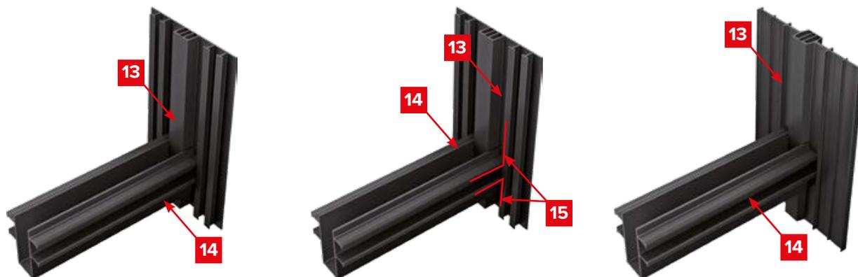
Производят срезку с компенсатора гидрошпонок EM 260/50 и IM 260/50 в участке (13). Вместе с этим с помощью строительного ножа удаляют фаску (лишний полимер) со стенки гидрошпонки FM-140/50 в участке (14). При подрезке рекомендуется зафиксировать гидрошпонки в зажимных приспособлениях (струбцинах) согласно п. 7.19.
