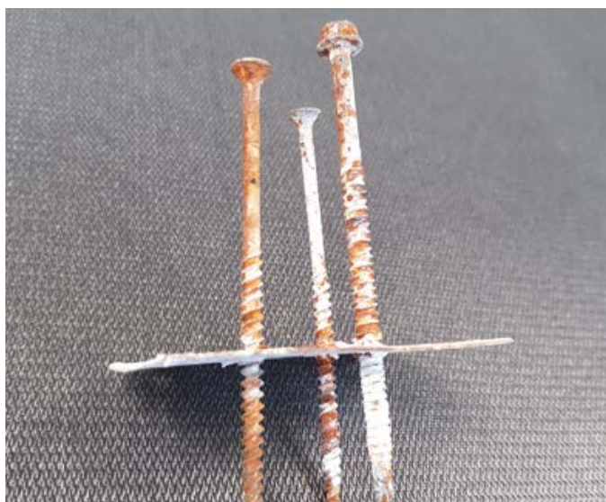
Обычные саморезы после нахождения в испытательной камере в течение 1000 часов
