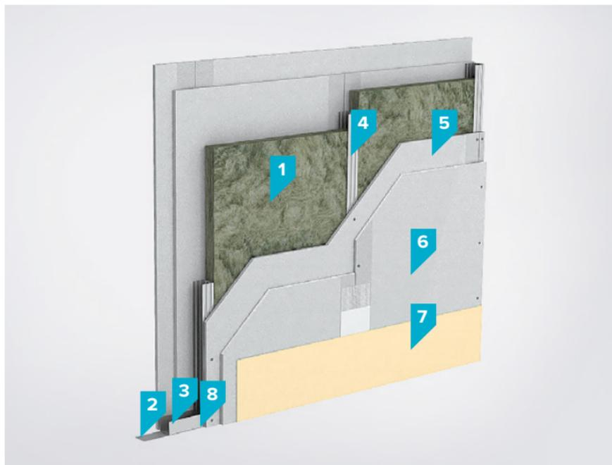
1. Звукоизоляционные плиты из минеральной изоляции на основе стекловолна ТЕХНОНИКОЛЬ Шумозащита
