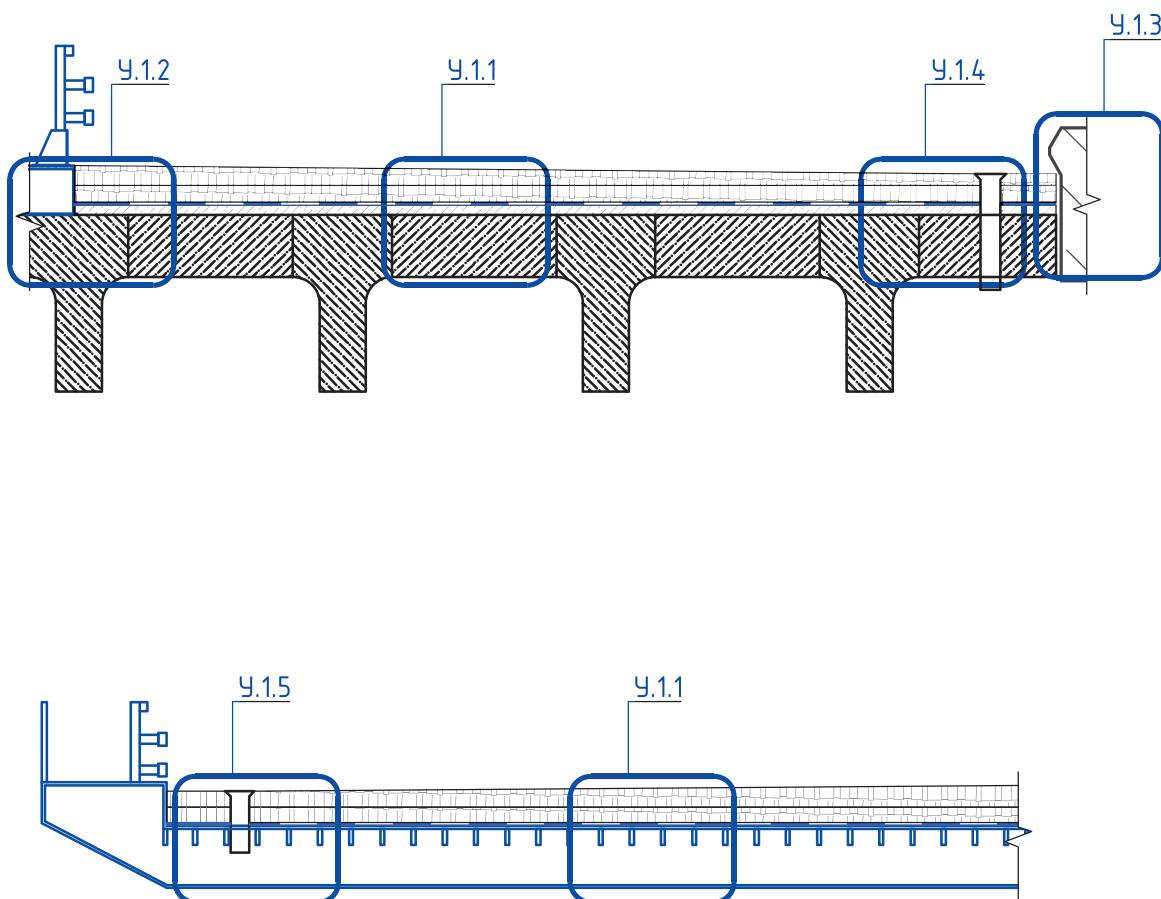
На рисунке В.2 изображен послойный состав систем дорожной одежды мостового полотна по железобетонному и металлическому основанию.
