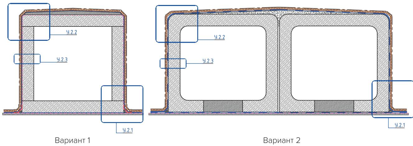
На рисунке В.14 изображена гидроизоляция в местах сопряжения вертикальной и горизонтальной поверхностей.
