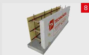
Произвести установку и вязку арматурного каркаса внутри опалубки. Продольные арматурные стержни каркаса установить в закладные детали под арматуру.
