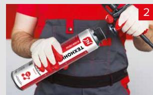
Снять с баллона защитный колпачок, навинтить пистолет на крестообразную насадку с резьбой «крест-кольцо».
