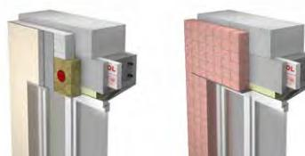
При устройстве монолитной перемычки с использованием U-образных элементов из пенобетона в полость U блока вставляется термовкладыш из XPS ТЕХНОНИКОЛЬ CARBON.
