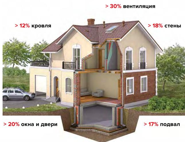
Для того, чтобы добиться максимального эффекта при утеплении дома, необходимо создать полностью замкнутый контур, то есть теплоизолировать все конструктивы здания:
