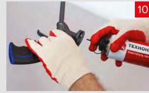
После завершения работ и в случае длительных пауз между работами необходимо тщательно очистить пистолет с помощью очистителя пены.
