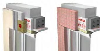
При устройстве монолитной перемычки с применением съемной опалубки предлагается устройство теплового контура из XPS ТЕХНОНИКОЛЬ CARBON.
