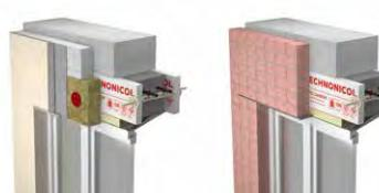
Использование несъемной опалубки из XPS ТЕХНОНИКОЛЬ CARBON и универсальных стяжек ТЕХНОНИКОЛЬ в качестве связей для устройства перемычек.
