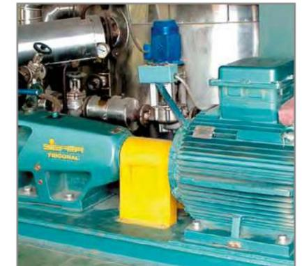
Гомогенизатор позволяет добиться высокого качества битумно-полимерной смеси.
