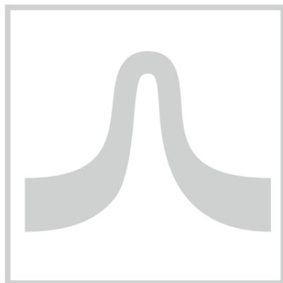
Значения получают на брусе радиусом 25 мм по ГОСТ 2678 для материалов класса А и радиусом 15 мм по ГОСТ EN 1109 для материалов класса Е. Минимальная температура, при которой материал при изгибе сохраняет гибкость и не трескается, является температурой гибкости. Замеры на брусе 15 мм для материалов класса А и Е отвечают более строгим требованиям, т.к. нагрузка на материал при таких изгибах значительно выше.
