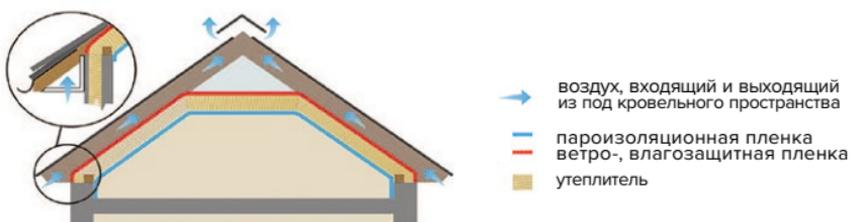
Рис. 1. Устройство вентиляции мансарды
