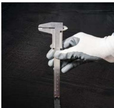
Контроль толщины мокрой пленки осуществляется при помощи специального диска или гребенки либо при помощи штангенциркуля.
