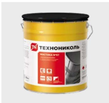
Мастика состоит из нефтяно-го битума, модифицированно-го полимерами, алюминиево-го пигмента, технологических добавок и органического рас-творителя. Образованное ма-стикой эластичное изоляци-онное покрытие эффективно защищает битумные кровли от ультрафиолетовых лучей и нагрева, а металлические кровли — от коррозии.
