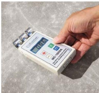
Одним из важных этапов при подготовке основания является контроль его влажности. Определение значений влажности бетона проводят в основном с помощью заводских приборов — влагомеров.
