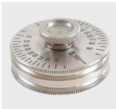
Диск для измерения толщины мокрой пленки.
