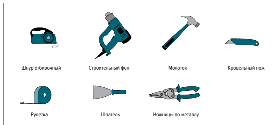
Рис. 1. Необходимые инструменты для монтажа
