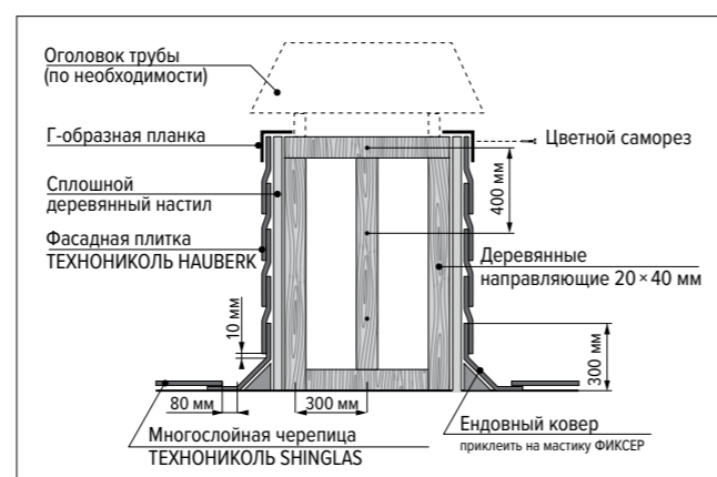
Рис. 26. Монтаж фасадной плитки на вентиляционную трубу
