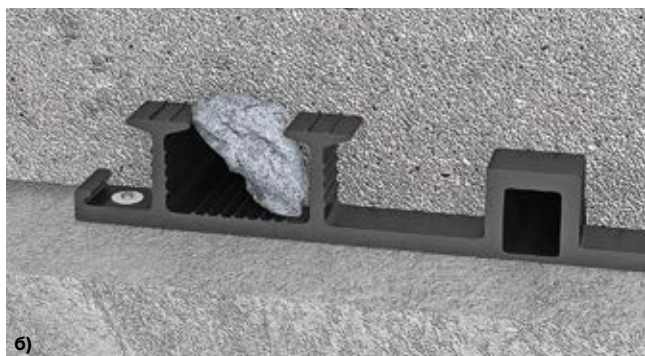
Рис. 3.8. Отношение между размером максимальной фракции крупного заполнителя бетона и расстоянием между анкерами гидрошпонки
