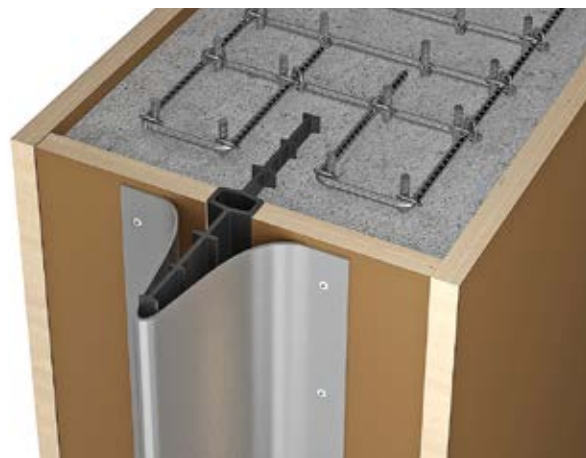
Рис. 4.17. Защитный короб для защиты свободной части гидрошпонки
