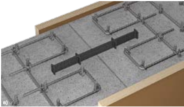
Рис. 5.3в,г. Этапы работ по установке гидрошпонок серии ТН Фундамент ТШВ
