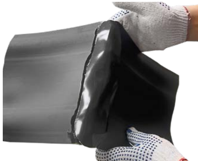
Рис. 4.16. Слой усиления на сварном шве гидрошпонки
