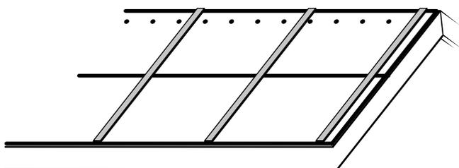
**Область применения:** Применяется в качестве подкладочного гидроизоляционного ковра в конструкциях скатных крыш с финишным покрытием из: битумной черепицы, композитной черепицы, металлочерепицы, битумных волнистых листов или натуральной черепицы.
