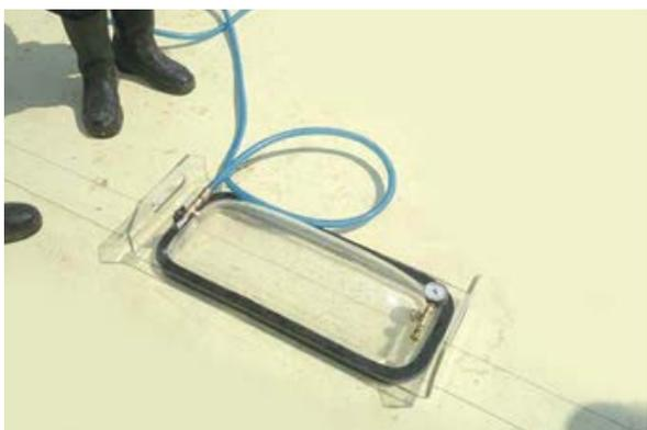
— Зону некачественного шва можно также определить с помощью вакуумного колпака. Для этой цели на линию сварного шва в тестируемом месте наносится мыльный раствор, на который устанавливается вакуумный колпак для выкачивания воздуха. Появление мыльных пузырей свидетельствует о некачественной сварке.
