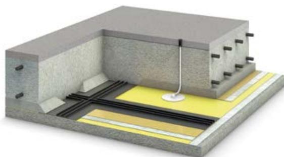
Такой способ снижает расход инъекционной трубки и обеспечивает кратчайший доступ инъекционного состава к изоляционному покрытию. В ходе реализации данного решения, однако, следует предусмотреть защиту трубок от механических повреждений в процессе монтажа арматурного каркаса и укладки бетонной смеси;
