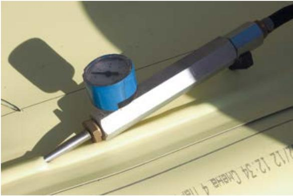
— Герметичность двойного шва контролируется с помощью подачи воздуха при заданном давлении (1,5-2 атмосферы) в проверочный канал через специальную иглу в течение 3 минут. Если давление не падает больше чем на 20 % от заданной величины, то сварной шов считается герметичным;
