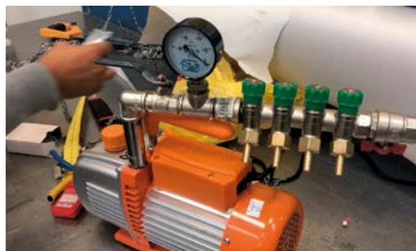
**10.12** При подключении по схеме 2 трубки подсоединяются ко всем инъекционным штуцерам и к одной гребенке, оборудованной манометром.
