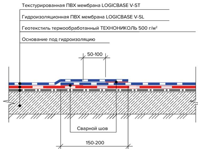
**8.1.9** Для большей надежности системы может быть предусмотрено секционирование поверхности текстурированной мембраны LOGICBASE V-ST / ECOBASE V-ST на изолированные сегменты (карты) при помощи внешних гидроизоляционных шпонок с обустройством дополнительной ремонтно-инъекционной системы. Такое устройство обеспечивает наличие сразу двух ремонтных контуров – между двумя гидроизоляционными мембранами и между мембраной и железобетонной конструкцией.
