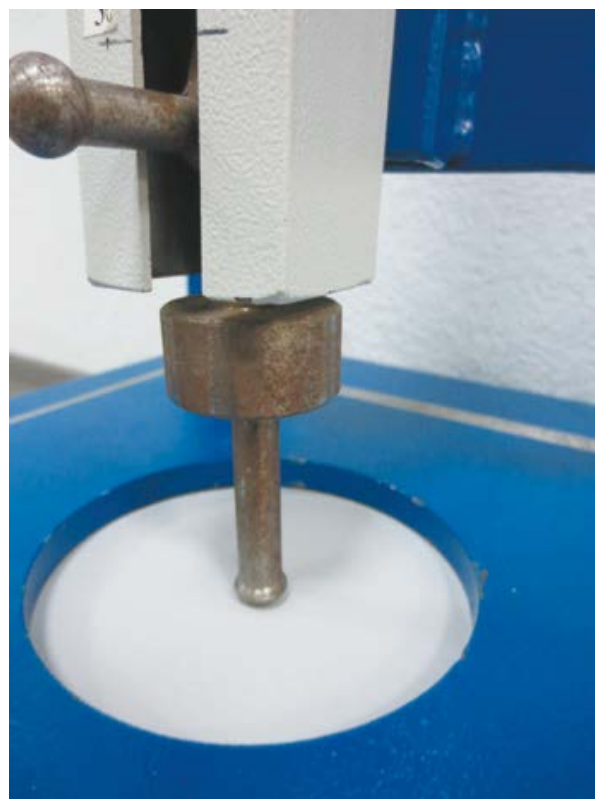
Рис. 4.5.4. Общий вид установки для проведения испытания на ударную прочность.
