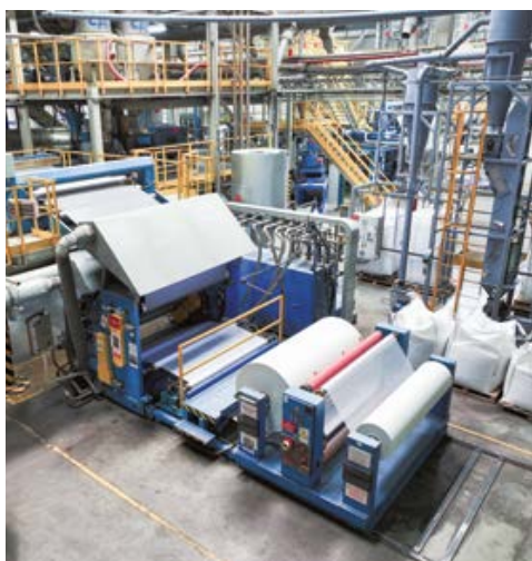
Рис. 4.1.1. Экструзионный способ производства ПВХ-мембран ТЕХНОНИКОЛЬ.
