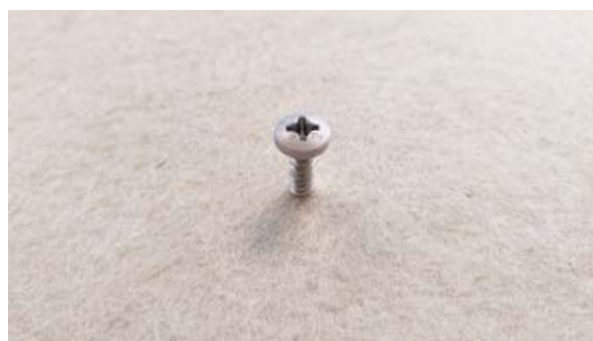
Рис. 3.4.2 а. Засверливание самореза в термообработанный геотекстиль.
