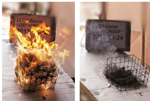
Рис. 4.5.10. Испытание по европейскому методу EN 1197, Test 1.
