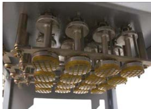
Рис. 2.2.2. Общий вид установки для проведения испытаний кровли на пешеходную нагрузку по методике европейского исследовательского центра BDA Testing.
