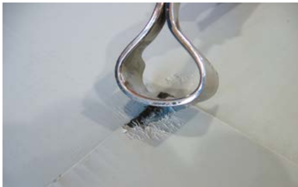
Рис. 5.2.14. Инструмент для подрезки нижнего полотна мембраны.
