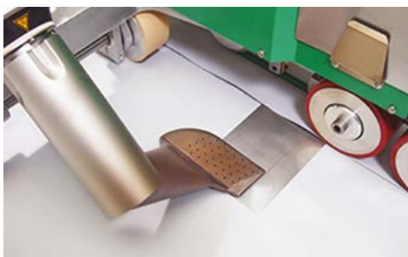
Рис. 5.2.8. Сварка с использованием металлической пластинки.
