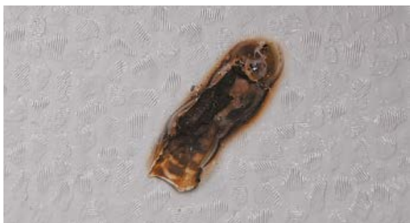
Образец мембраны толщиной 1,5 мм после испытания.
