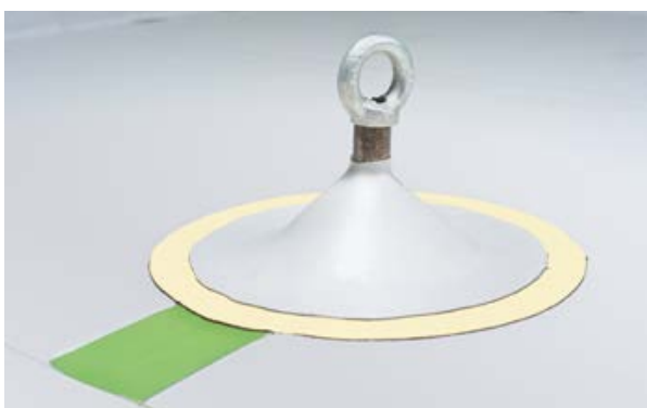
29. Проверьте качество сварных швов пробником. Сверху стяните конус хомутом и заполните ПУ-герметиком ТЕХНОНИКОЛЬ Logicflex.
