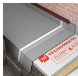
**7.** Установите краевую декоративную рейку **PLANTER Profile** на верхнюю часть **PLANTER Geo** на цоколе. Вместо декоративной рейки **PLANTER Profile** допускается использование металлических профилей для крепления гипсокартона и др.
