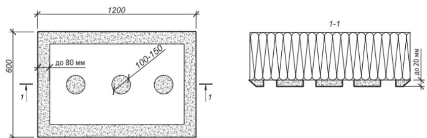
Рис. 7. Схема точечного (контурно-маячкового) нанесения клея на плиту
