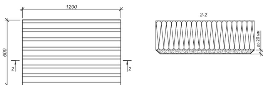
Рис. 5. Схема сплошного нанесения клея на плиту
