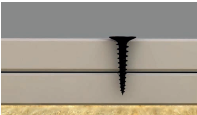
Рис. 11. Соединение двух листов сухой стяжки при помощи самореза
