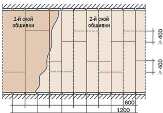
Рис. 14. Схема обшивки листами ГКЛ
