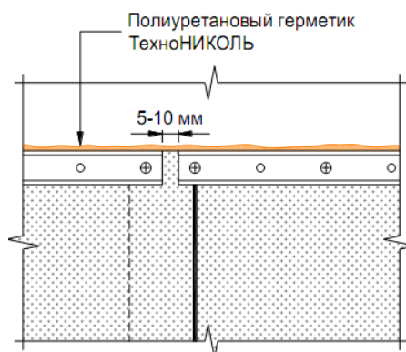
Рисунок 4.13 – Установка смежных краевых реек
