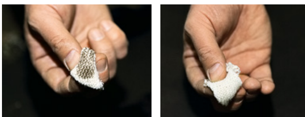
Рис. 3.5. Определение высыхания праймера
