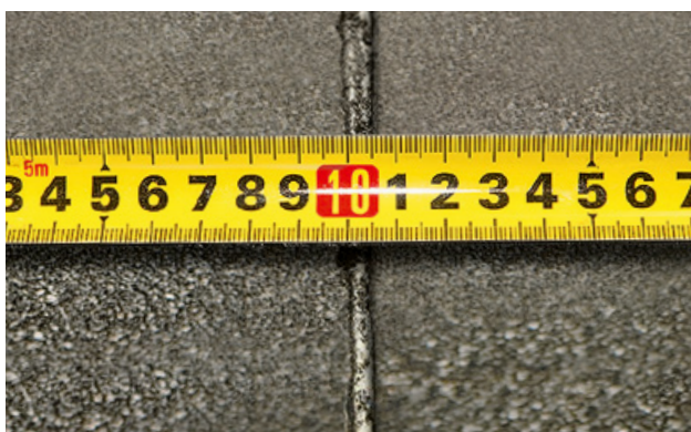
Рис. 4.6. Вытек битумной массы из-под кромки материала
