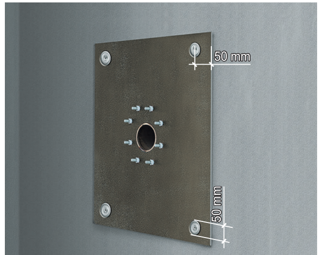
Şəkil 5.3. Şaquli səthdən üfüqi səthə keçid və boru keçid yerlərində gücləndirici qat mexaniki fiksasiyası
