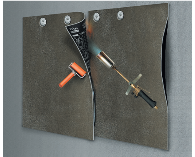
Şəkil 5.5. Üst-üst düşənlərin sonrakı qaynaqlanması ilə rulonların mexaniki fiksasiyası
