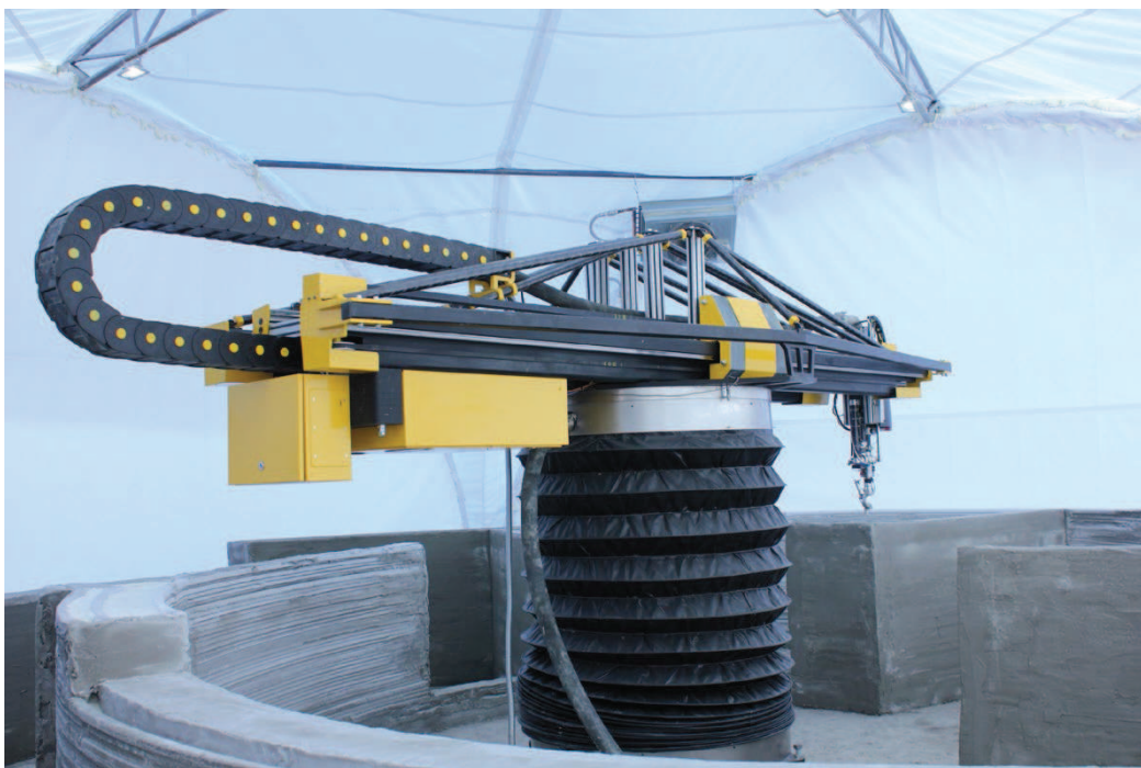
Мобильный принтер, созданный в компании Aris Cor, предназначен для работы непосредственно на стройплощадке
