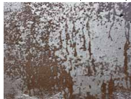
Естественное высыхание праймера на огрунтованной поверхности
