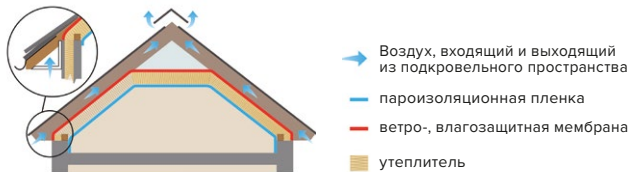
Рис. 4.1. Устройство вентиляции мансарды
