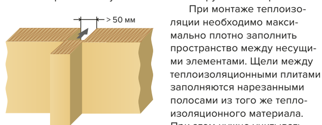
Рис. 1.7. Заполнение зазоров между плитами теплоизоляционного материала
